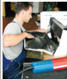
Konsequent vereinfacht Berbel die Produktionsabläufe. So werden die Hauben aus fertigen Blechteilen zusammengesetzt.
