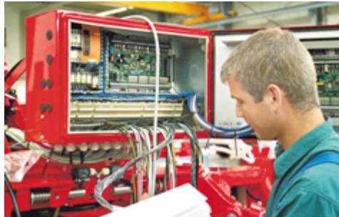
Teupen-Mitarbeiter Mark Lösing bei der Endmontage der komplizierten Steuerungstechnik, die in den Hubarbeitsbühnen Störungen selbstständig erkennt, auswertet und die entsprechenden Daten per Mobilfunk an den Service übermittelt.
