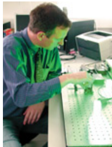
Impex-Mitarbeiter Jens Meyer prüft ein Lasersystem, das die Schichtdicke von Halbleitermaterialien misst. Foto: Hertel
