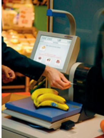
Die Waage lernt selbsttätig: Über ein Objektiv neben dem Display erkennt die Waage automatisch die aufgelegte Obst- oder Gemüsesorte.
