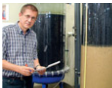
Prof. Christian Becke, Lehrgebiet an der Fachhochschule Münster sind Wasserversorgung und Wassergüterwirtschaft. Hier hält er das übliche Filter-Modell, bei dem das Wasser zunächst durch Anthrazit und dann durch Sand läuft. Im Hintergrund der neue Einschichtfilter, der nur mit Anthrazit auskommt. Foto: Herzel
