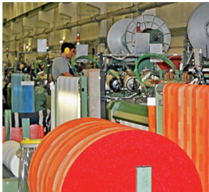
Auf 98 Webmaschinen werden bei den Schmitz-Werken Markisen- und Dekostoffe von bis zu 3,40 Metern Breite produziert.
