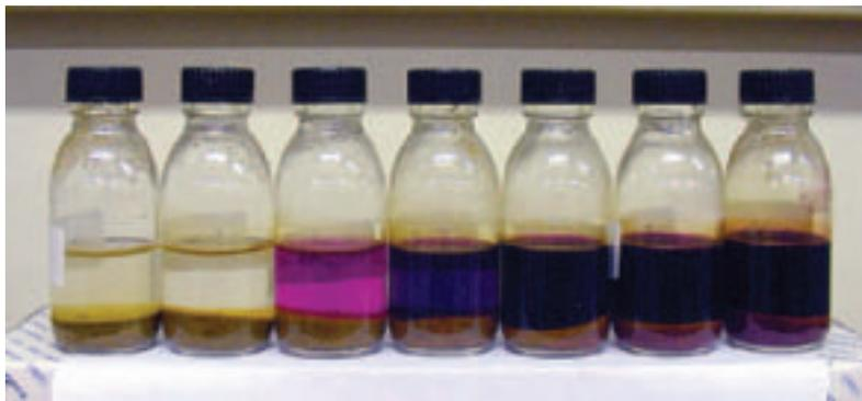
*Bild 2: Versuchsstand mit Kiessandproben nach einer Reaktionszeit von 8 Tagen*
