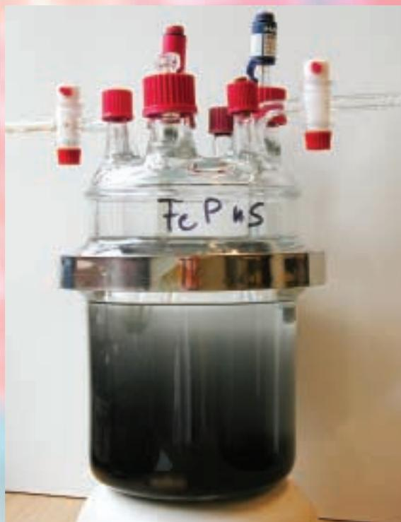
*Sedimentation von suspendiertem Nano-Eisen in dem Spezialbehälter für die Labor-Versuche*
