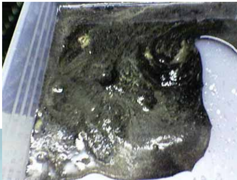
Abbildung 6: Bakterienschlamm aus der Strippanlage
