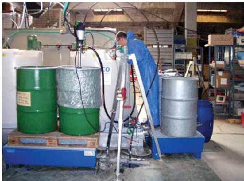
Anlage zum Anmischen der Fe-Suspension aus Mikro/Nano-Eisen und Wasser
