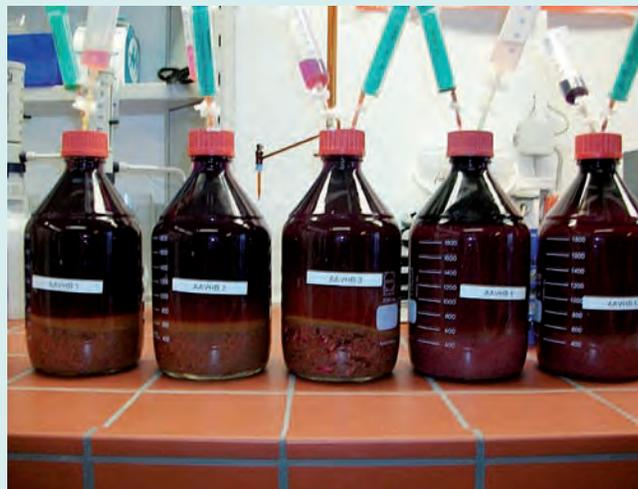
Zur Bestimmung des „soil oxygen demand (SOD)“ wurden Laborversuche mit standort eigenem Boden durchgeführt
