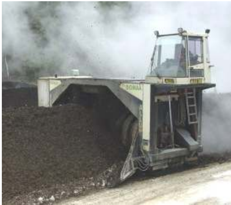
Abbildung 4: Mietenumsetzer in einer Kompostieranlage
