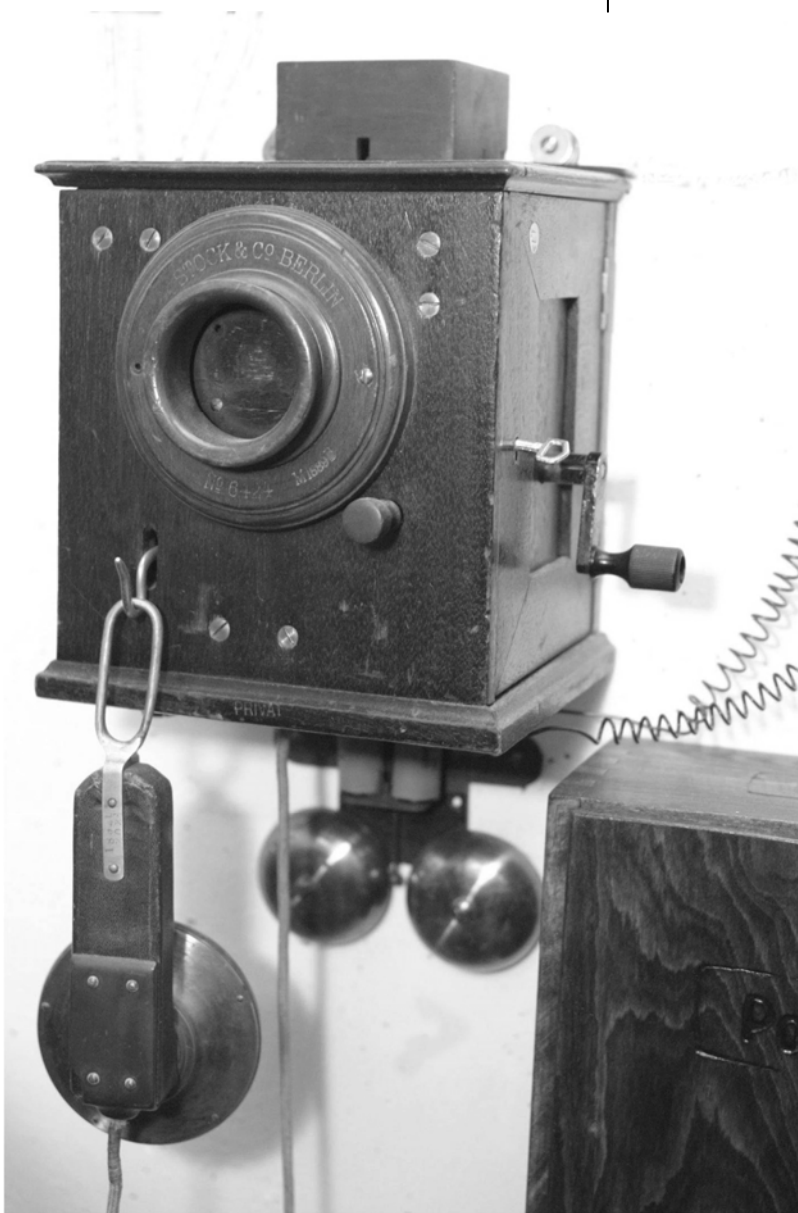
Fernsprechwandapparat für OB-Betrieb (Ortsbatterie-Betrieb) von 1898. Rechts das Batteriekästchen.
