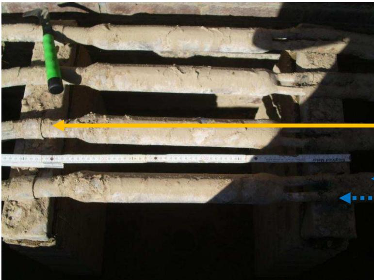
Abbildung 20: Lagerung der 4 Lötstellen der NF-Kabel
