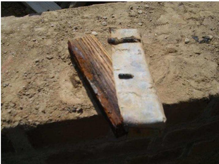
Abbildung 30: Holzstück mit Bleiumhüllung (aus Abb. 29)
