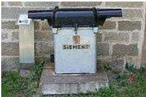
Abbildung 8: Pupinspulenkasten aus deutscher Produktion Siemens & Halske 1937
