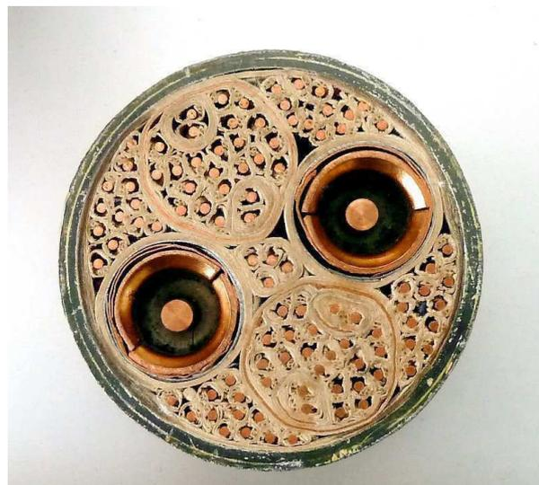
**Die Bilder zeigen ein Breitband Fernkabel Bauform: 52d, Jahr: 1936 Hersteller: Siemens Halske AG, Berlin Das Kabel besteht aus 50 symmetrischen Doppeldrahten und 2 Koaxial Leitungen. Dieses Kabel ermöglichte zum ersten Mal einen Gegenrichtungsbetrieb.**
