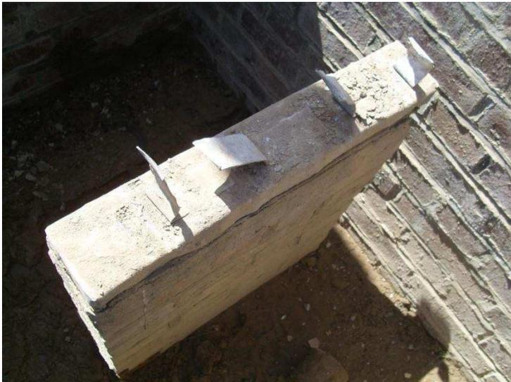
Abbildung 24: Bleikasten mit Bleibändern nach der Demontage der Anlage
