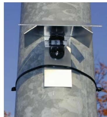
**Abbildung 1:** Passivsammler unter Schutzdach
