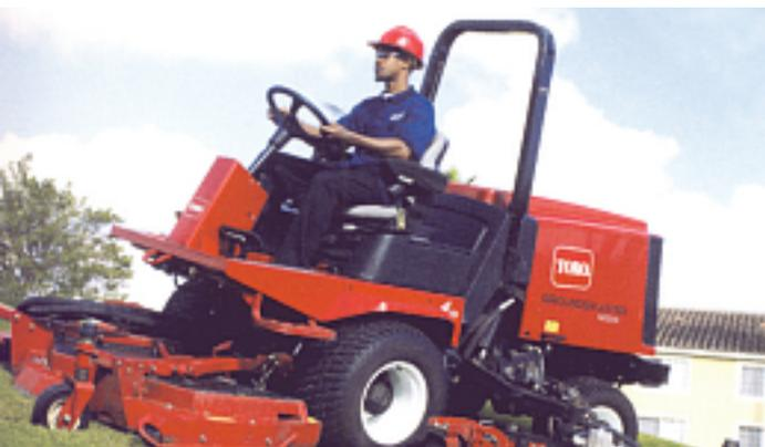
**Groundmaster 4000-D:** Mit einer Schnittbreite von 3,4 m der leistungsfähigste derzeit erhältliche Mäher. FOTO: SCHAUFENSTER
