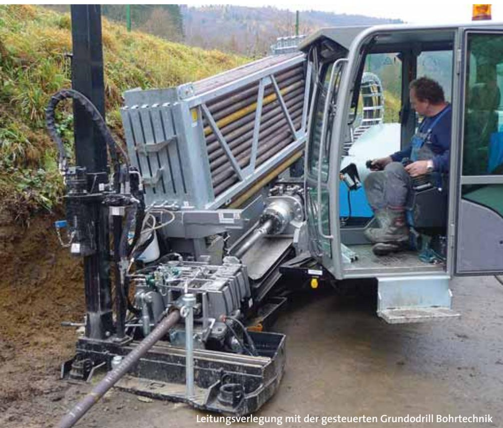
Leitungsverlegung mit der gesteuerten Grundodrill Bohrtechnik
