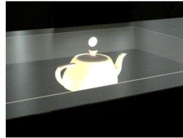
**Projektor-Kamera-System.** Links: Gefärbtes Tiefenbild mit detektierter 3D-Kopf-Position einer Person. Mitte und rechts: In Abhängigkeit von der Kopf-Position einer benutzenden Person werden verschiedene Ansichten eines Objektes projiziert. Bilder aus Garstka & Peters, "View-dependent 3D Projection using Depth-Image-based Head Tracking", PROCAMS 2011.
