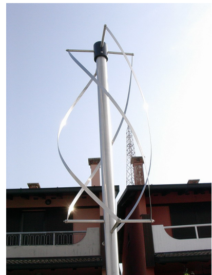
quadrafil helix antenna (image courtesy of: Hans-Jürgen Lüthje, http://www.satpix.de )
