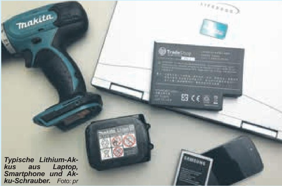
Typische Lithium-Akkus aus Laptop, Smartphone und Akku-Schrauber. Foto: pr
