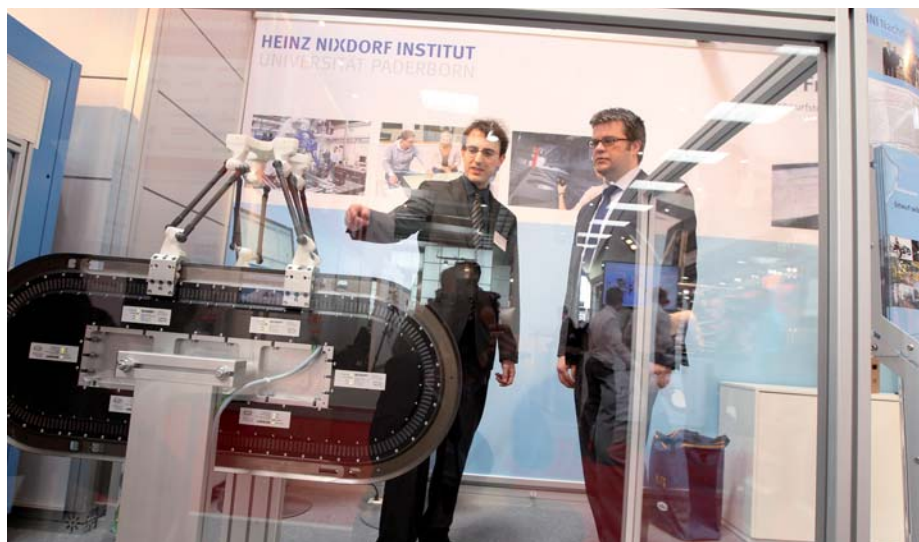
Scientific Automation Demonstrator: der Parallelroboter kann entlang der Schiene in drei Dimensionen positioniert werden und dabei auch die Kurven durchfahren.
