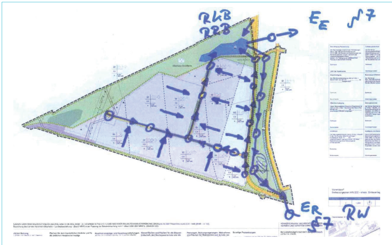
Abbildung 18: Bebauungsplan InN 222 – ehemalige Sinteranlage – Entwässerungsskizze
