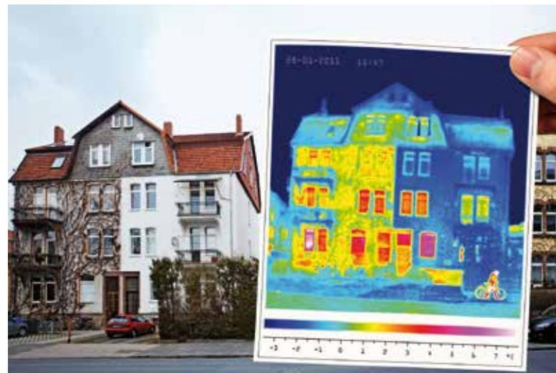
Abb. 25\_\_ Halb isoliertes Haus
