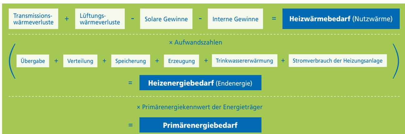
Abb. 16\_\_Vereinfachtes Schema der Energiebilanz nach EnEV
