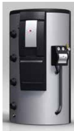
Abb. 74\_\_Multi-Speicher ermöglichen die Einbindung mehrerer Wärmequellen. Sie haben eine dicke Wärmedämmschicht; Heiz- und Solarstationen werden außen angedockt. Quelle: Wolf
