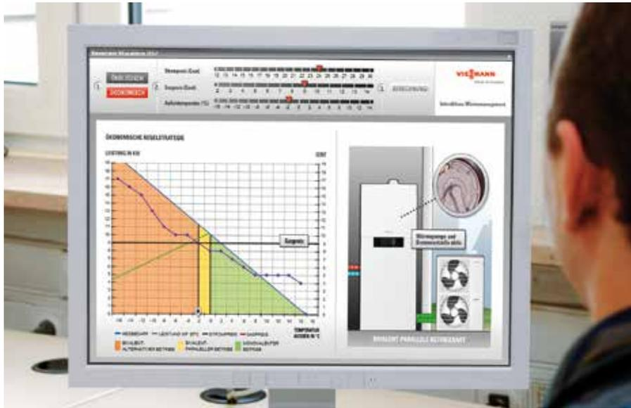
Abb. 77\_\_Die Regelung von Gas-Wärmepumpen-Heizungen legt automatisch den Punkt fest, an dem vom Wärmepumpen- auf den Gasbetrieb umgeschaltet wird. Der Nutzer hat die Wahl zwischen einer ökonomisch und einer ökologisch optimierten Betriebsweise. Quelle: Viessmann
