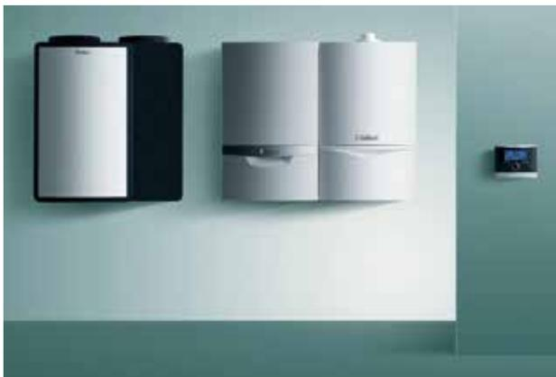
Abb. 71\_\_Bei diesem wandhängenden Gas-Wärmepumpen-Hybrid-System liefert die Wärmepumpe mit 3 kW Leistung die Basisenergie für die Raumheizung. Spitzenlast und Warmwasserbereitung deckt die Gasheizung ab. Quelle: Vaillant
