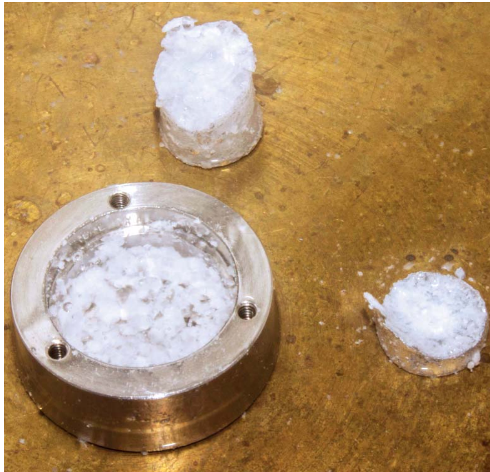
Abbildung 2: Hochdichtes amorphes Eis auf einer stickstoffgekühlten Unterlage: In kleinen Zylindern von 8 mm Durchmesser wird HDA von Innsbruck nach Dortmund verschickt. Dort wird es zerkleinert und in die Messzelle für die Dielektrizitätsspektroskopie gefüllt (links unten).
