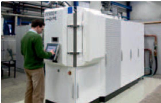
Werkzeugbeschichtung mittels einer modernen PVD-Beschichtungsanlage
