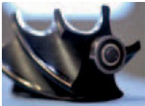
Nebenrotor eines unsynchronisiert trockenlaufenden Schraubenladers
