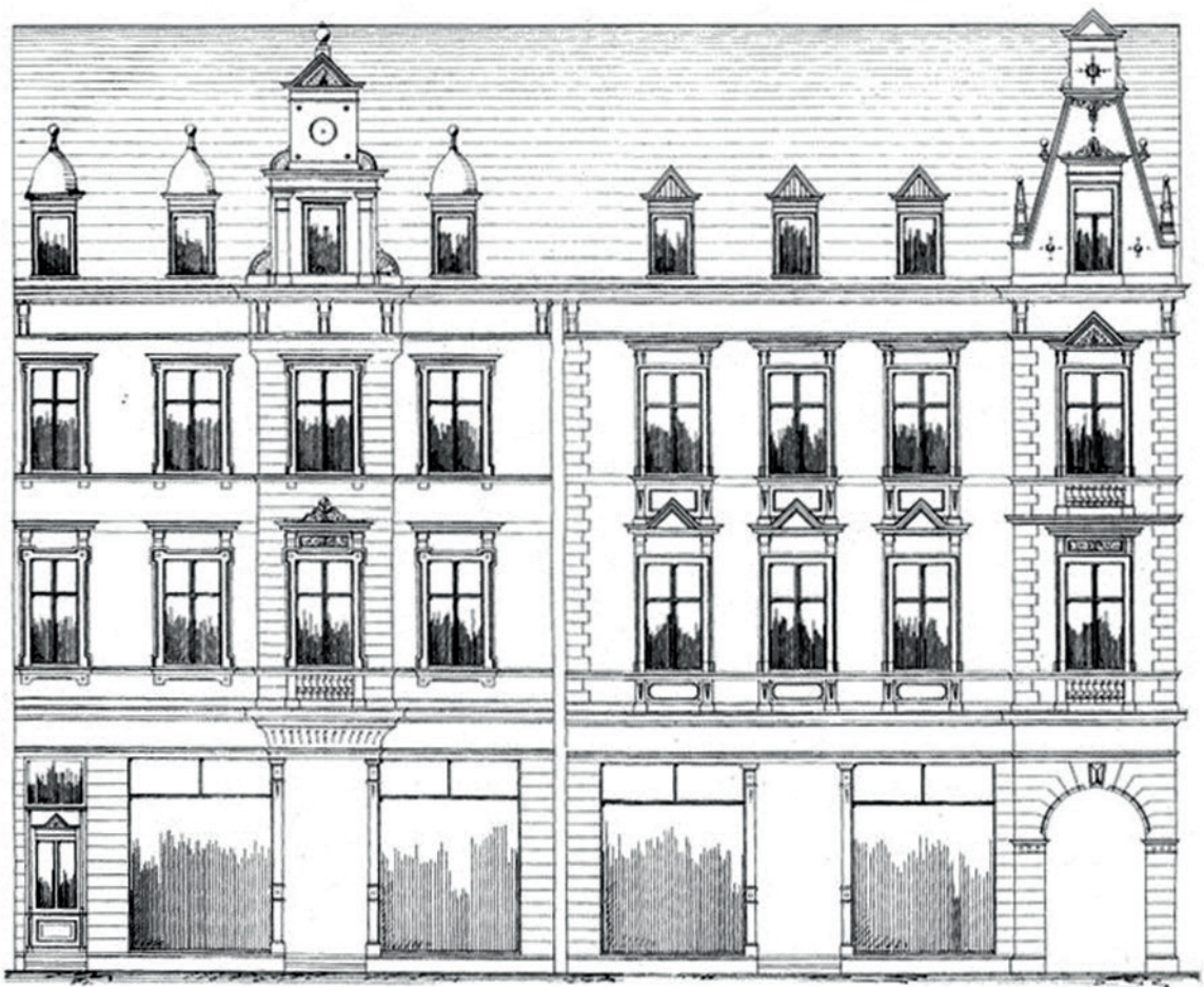
Abbildung 9: Nachträgliche Schaufensteröffnungen mit Oberlichtern in einem typischen Wohnhaus der Jahrhundertwende
