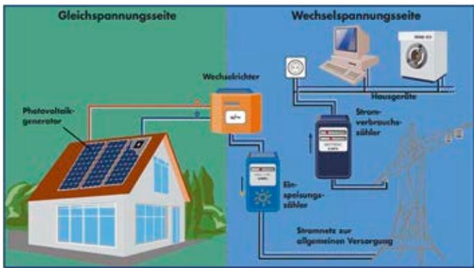
Funktionsprinzip einer Fotovoltaikanlage –
