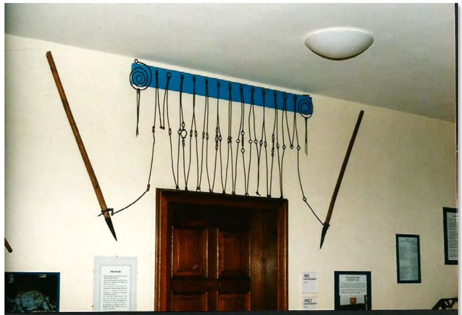
Messkette (ca. 1840) mit Kettenstäben und Setznadeln. 5 Ruten lang, das entspricht einer Länge von 18,83 m. Foto: Peter Sukkau
