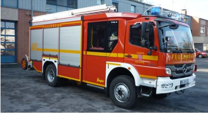
Die neuartige Kabine (Ziegler-Cap) mit mehr Platz für die Mannschaft und deren Ausrüstung, bietet einen hohen Sicherheitsstandard. Ausgestattet ist das Löschgruppenfahrzeug mit einer Feuerlöschkreiselpumpe mit einer Leistung von 2.000 Liter pro Minute, einem Löschwasservorrat (1.800 Liter) und einem Schaumtank (200 Liter), sowie einer vollautomatischen Schaum-Zumischanlage. Neben der umfangreichen Ausstattung ist ein tragbarer 13kVA Stromerzeuger, sowie ein pneumatischer Lichtmast verbaut.
