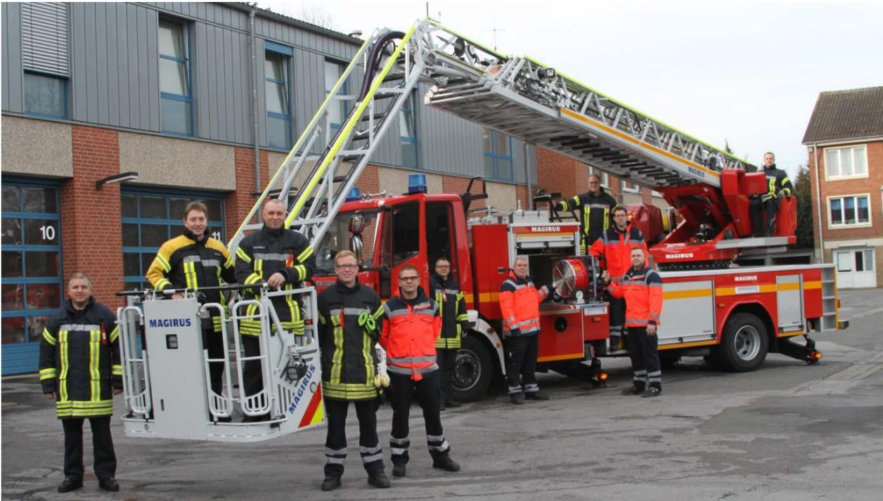
Der Rettungskorb ist für drei Personen zugelassen und abnehmbar. Er ist mit 1 Multifunktionssäulen für Wenderohr oder Krankentragehalterung ausgestattet. Menschenrettungen sind in einer Höhe von bis zu 30,5 Metern möglich.
