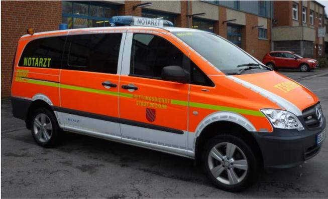
Das Notarzteinsetzfahrzeug ist auf dem neuesten Stand der Technik und auf einem Mercedes Vito 3 t Allrad-Fahrgestell mit 163 PS aufgebaut und beinhaltet zum Beispiel ein vollautomatisiertes Getriebe, ein Navigationssystem und viele Airbags, die die Sicherheit des Personals während der Fahrt auf dem Fahrzeug gewährleisten.
