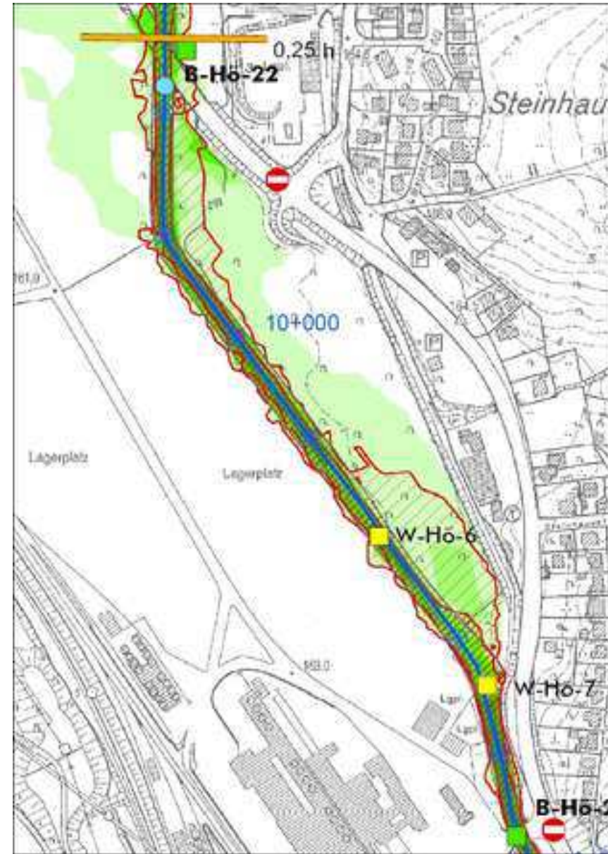
Abb. 6: HQ 25 im Bereich „Sonnenschein“
