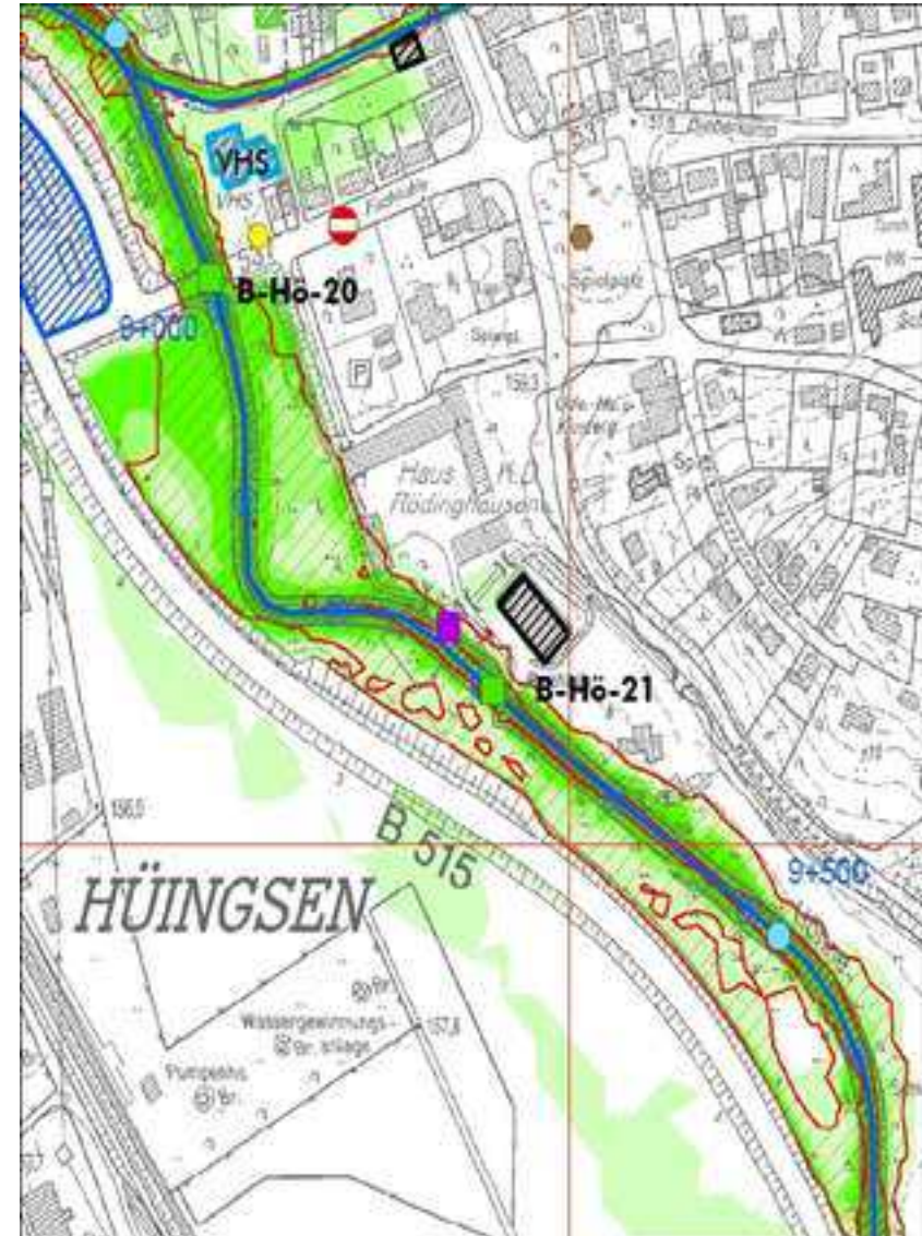
Abb. 9: HQ 25 im Bereich „Im Ohl“
