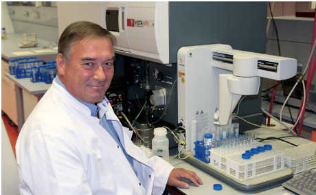
Laborarbeitsplatz Herr Dahm: ICP-OES-Spektrometer
