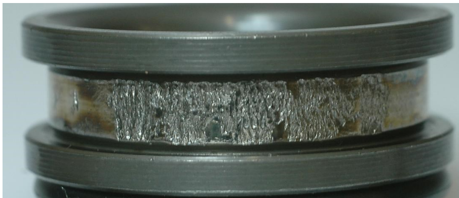
Bild 6.45: Ausgedehnte Grübchenbildung auf einem Planetenradlagerinnenring
