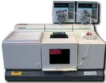
Bild 2.3: FT-IR-Gerät zur Untersuchung der Ölqualität [29]
