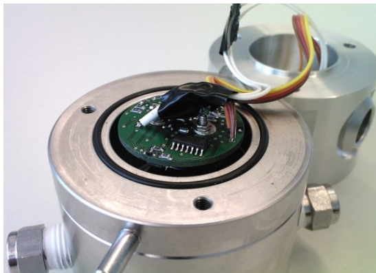
Bild 4.6: Integration im Sensorgehäuse [62] Bild 4.7: Gesamtdarstellung des Sensorsystems [62]
