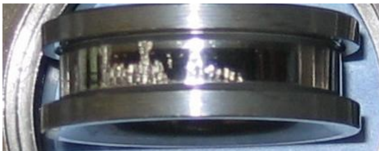
Bild 6.56: Schälungen auf einem Planetenradlagerinnenring
