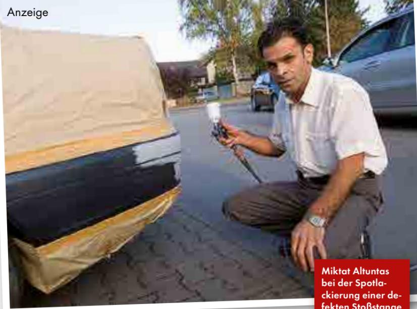
**Miktat Altuntas bei der Spotlackierung einer defekten Stoßstange**
