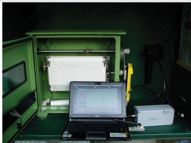
Bild 2: Pegelanlage Lipperreihe/Menkhauserbach mit abrufbarem GPRS-Datenlogger der Fa. Terra Transfer GmbH
