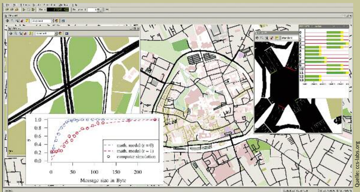
Abb. 3: Mit dem Simulationswerkzeug Veins ist es möglich, realistische Verkehrsflüsse zu erzeugen und Fahrzeugkommunikationsanwendungen in diesen Umgebungen zu erproben. Gezeigt ist ein Modell von Paderborn.
