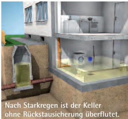
Nach Starkregen ist der Keller ohne Rückstausicherung überflutet.
