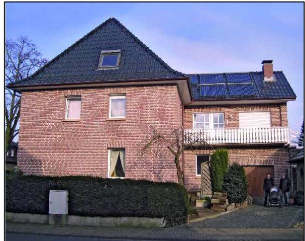
Das neue Zuhause der Familie Berendsen. Ein gut gedämmtes Dach, die neue Fassadendämmung sowie eine neue Pelletheizung und eine Solaranlage sorgen für einen sehr geringen Heizenergieverbrauch.
