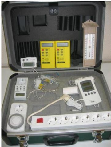
Mit der Hilfe von Minimum-Maximum-Thermometern können z. B. bei der Erkundung von Energiesparmöglichkeiten in Gebäuden die niedrigsten und höchsten Temperaturen während eines Zeitraumes zwischen zwei Ablesungen in einem Raum ermittelt werden (z. B. Temperaturabsenkung während der Nacht).
