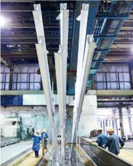
Ein metallischer Zinküberzug verhindert Korrosion und Abnutzung
