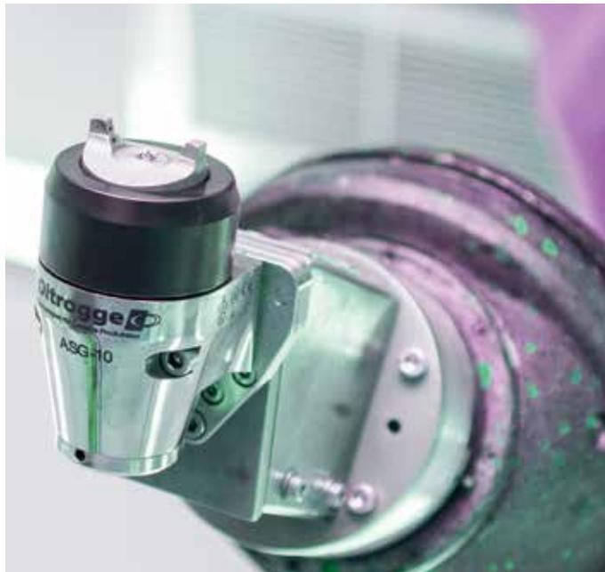
Die ASG 10 im Einsatz – am Roboterarm montiert
