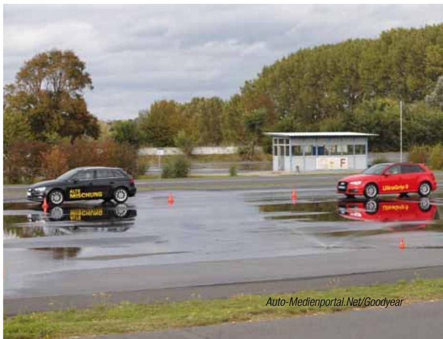
dem gleichen Reifen, aber mit einer Mischungstechnologie von vor 20 Jahren ausgestattet ist, 41 Meter bis zum Stillstand. Während das Auto mit den Winterpneus mit aktueller Mischung bereits steht, ist das Fahrzeug mit den Reifen aus der Mischung von vor 20 Jahren noch mit 34 km/h unterwegs.
