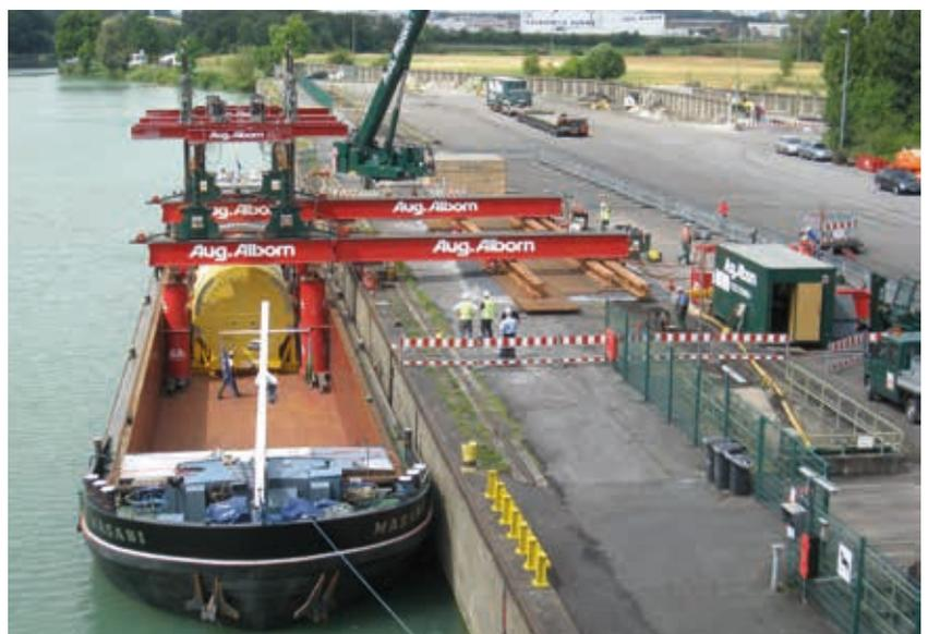
Schwertransporte per Schiff werden immer wichtiger: Ausladen eines 480 Tonnen schweren Generators in Hamm.
