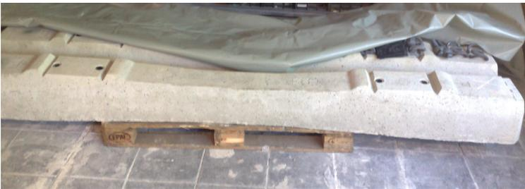
Abb. 5.1: Prüfobjekt der ersten Beispielapplikation, Bahnschwelle aus Spannbeton
