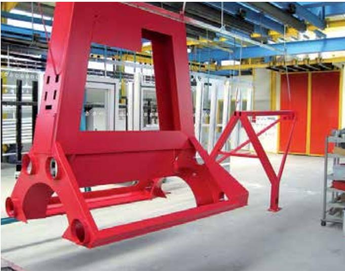
**Großteilpulverbeschichtung XXL 8X 3,3 X 2,5 Meter, 4 Tonnen**
