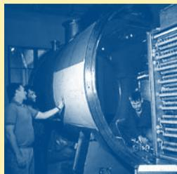
temperatur-Brennstoffzelle an der Universität Bielefeld. Sie erzeugt Strom und Wärme direkt aus Gas.
