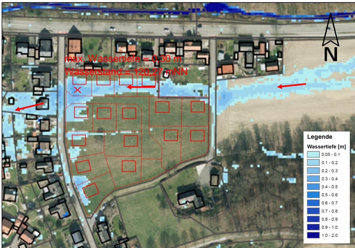
Abbildung 5: Überschwemmungssituation Baugebiet „Austenkamp“ bei einem 100-jährigen Regenereignis gemäß hydrodynamischer Simulation (FloodArea)
