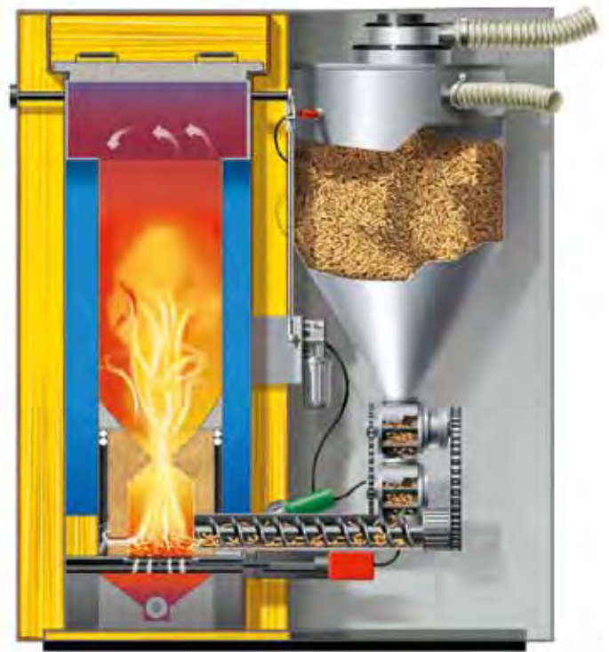
Modernste Technik, sauberste Verbrennung: Die Pelletskessel von Hargassner.
