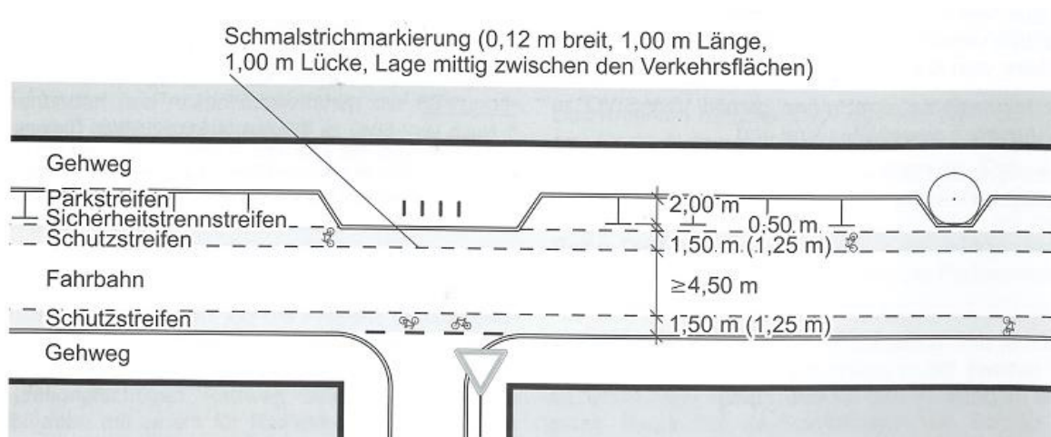
Abb. 71: Mögliche Ausprägungen eines Schutzstreifens
