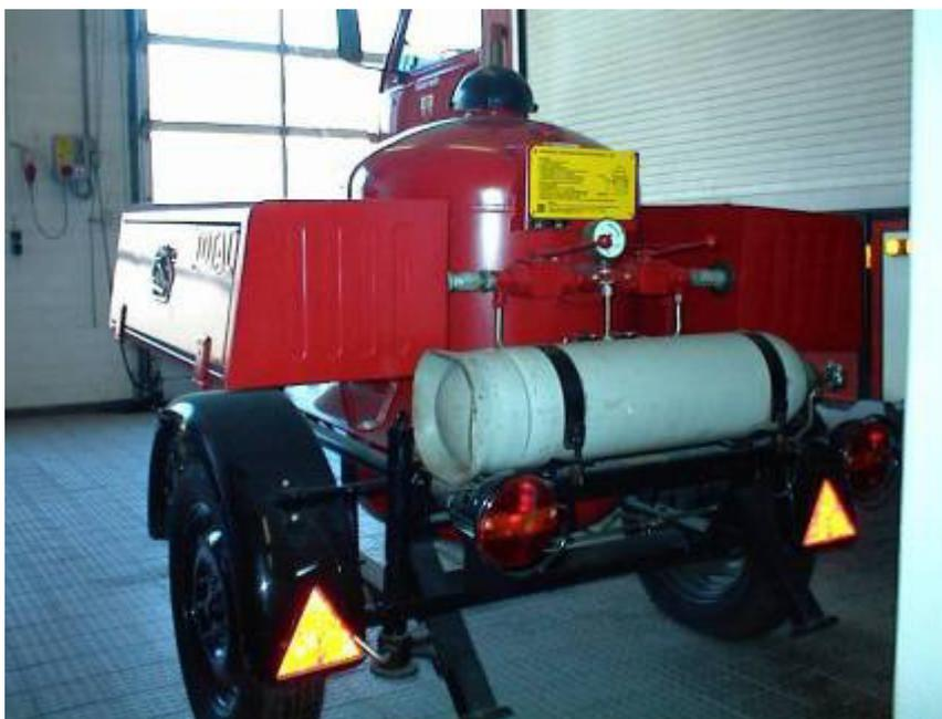
**Pulverlöscher 250 kg P 250** Standort Löschzug Vlotho
