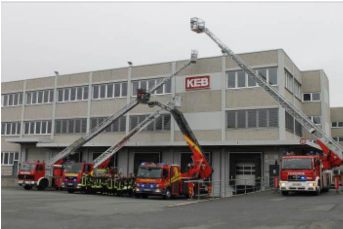
Bei keinem anderen Feuerwehrfahrzeug ist der richtige Aufstellungsort so wichtig für den Einsatzerfolg wie bei der Drehleiter. Schon ein paar fehlende Zentimeter bei der Drehleiteraufstellfläche können darüber entscheiden, ob die Drehleiter an die zu rettende Person herankommt oder nicht. Dies wird immer wieder trainiert. Gerade die Erfahrung von erfahrenen Drehleitermaschinisten ist hier von Vorteil und wird bei der Ausbildung an die jungen Kameraden weitergege-
