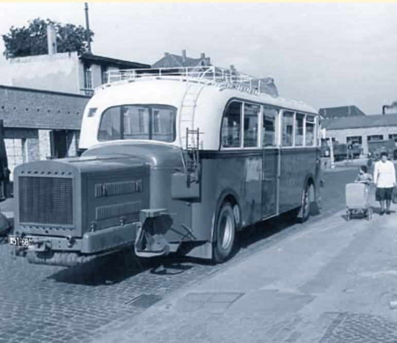
Der Bus mit der Dampfmaschine um 1949: der Betrachter könnte meinen, hinten sei vorne.
