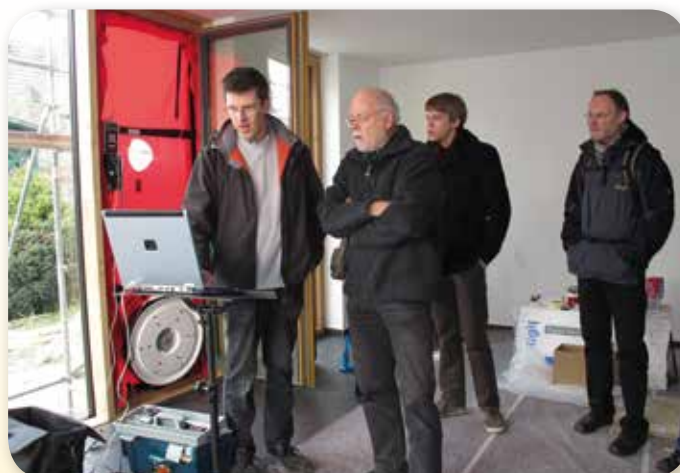
Ulrich Honigmund beim Luftdichtheitsmessung (Blower-Door-Messung) zur Bestimmung des Luftwechsels und zur Leckageortung
