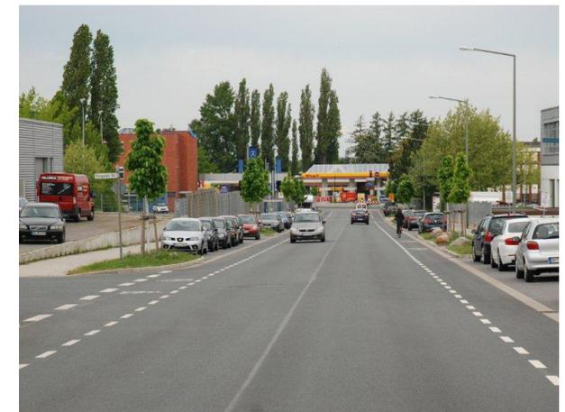
Abb. 72: Beidseitiger Schutzstreifen auf Hauptverkehrsstraßen
